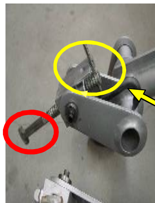
鉄蓋の地切りを行う ① T型フックを選択
